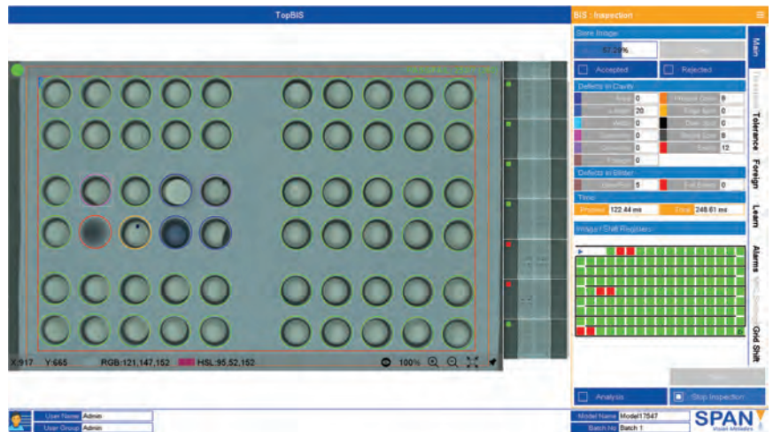
图3: 定制的软件用户界面，使操作者能够看到泡罩包装上缺陷的具体位置和特定属性。
