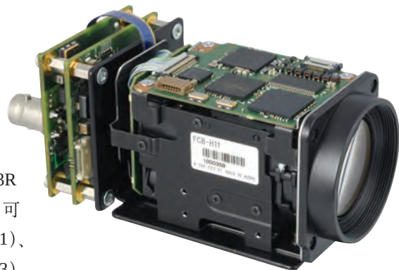
图1：在FCB-H11相机中，Active Silicon公司使用单个2.5Gbps CXP-2链路来支持相机的所有HD模式（1080i和720p，50Hz或60Hz），相机中使用的是索尼的1/3英寸200万像素CMOS图像传感器。
