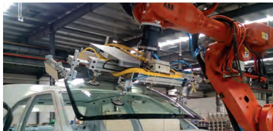
图1：在机器人末端执行器上，内置有四个Gocator 2300系列3D智能传感器，Bluewrist工程师利用它们来监视挡风玻璃孔上四个临界点的位置。
