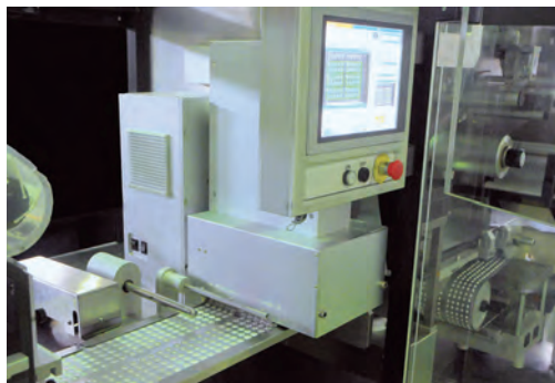
图1：SPAN Inspection System公司已经开发出一种基于机器视觉技术的泡罩包装检测系统，命名为Blisbeat。
