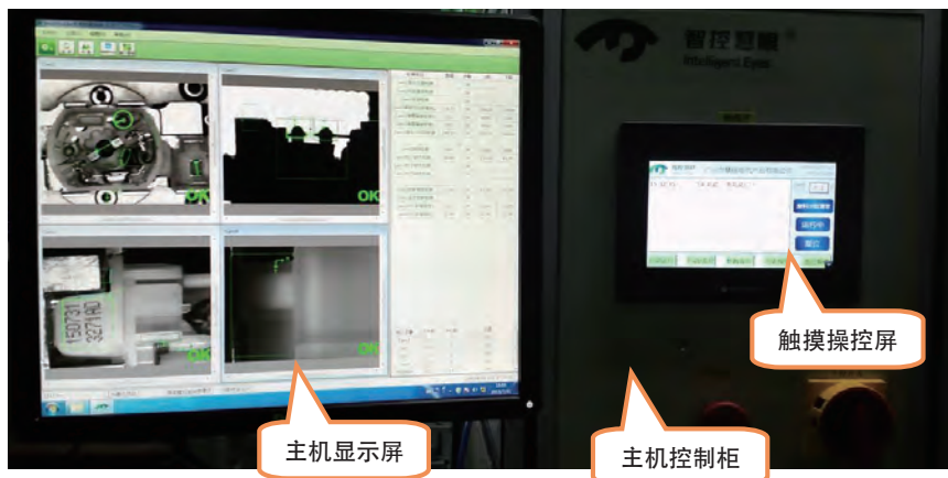
图2：慧眼FM420-170多相机检测系统的控制和显示部分。
