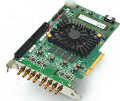
图3: Kaya Instruments公司的Komodo CXP图像采集卡能够以单路、双路、四路或八路模式, 从多达八路CoaXPress链路接收图像数据。
