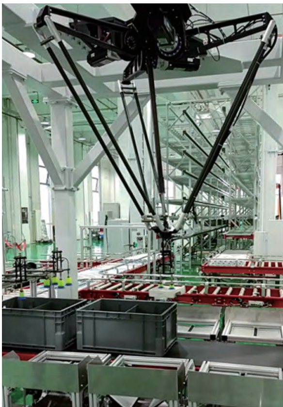
图3：机器人手定位抓取。
