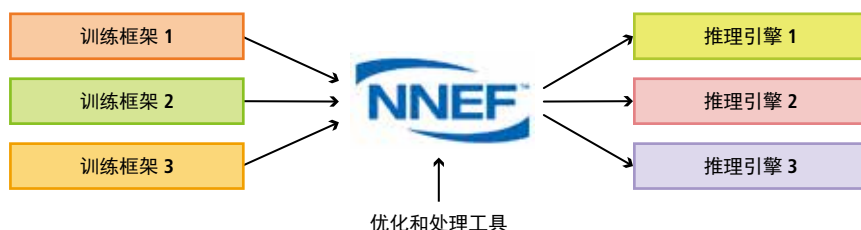
图1：神经网络交换表允许硬件制造商在训练框架和推理引擎之间，可靠地交换训练后的神经网络。
